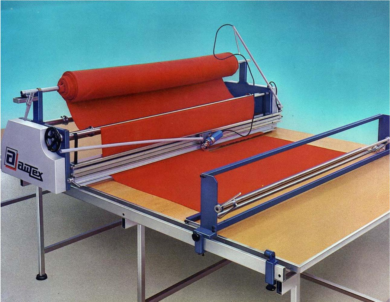
Máquina manual de extender tejidos, concebida de una máxima simplicidad y ligereza pudiendo extender deversas clases de tejidos una sola persona con un mínimo de esfuerzo personal. Es adaptable a todo tipo de mesa, siempre que el tablero sobrepase en 20cm el ancho útil de la máquina. Podemos efectuar extendidos cara sobre cara y en zigzag, sin necesidad de sustituir o cambiar ningun elemento de la máquina.
